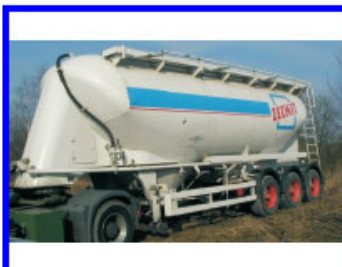
SPITZER SF 2437, r.v.1997 návěs na přepravu cementu celohliníkový, 37m3, nosnost 28,8t, ABS
