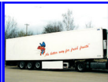
SOR SP 71, r.v.1998 13,6m, vnitřní výška 2,6m, celková hm.34.500 kg, už.hm.25.620 kg, schránka na palety, zvedací náprava, pneu 80-80%
