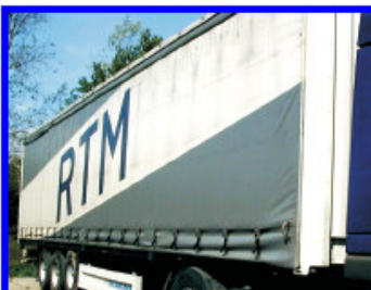
KRONE SDP 27, r.v.1999 3osý, dělená shrnovací plachta, zvedací náprava, výška pod plachtu 2,7 m, 34 palet, 13,6m, už.hm.29.200 kg
