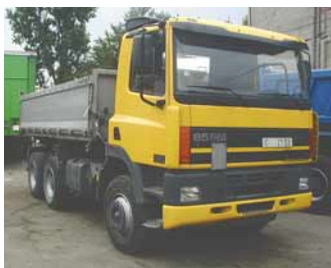
DAF CF 85.380 sklápěč S3, 6x4, r. v. 1999 AL korba, plachta, centr. mazání, závěs, celk. hmot. 26 t, užít. hmot.14,1 t, 172 000 km
