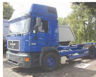
MAN 26.463 FNLLW podvozek BDF, 6x2, r. v. 1998 nosič vým. nástaveb, vys. kabina, 2 lůžka, zadní zved. náprava, závěs pr. 40 mm, celk. hmot. 26 t, užít. hmot.17,1 t , nové pneu, nezáv. topení, 333 000 km možnost pronájmu s následným odkupem (č. 2002038F) cen. kategorie III.
