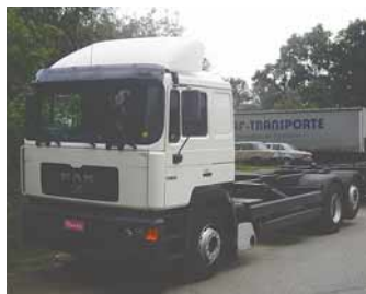
MAN 26 414 FNLLC podvozek BDF, 6x2, r. v. 2000 nosič vým. nástaveb, nízká kabina, retardér, klíma, převod. ZF, 1 lůžko, závěs pr. 40, zadní zved. náprava, střeš. spojler, celk. hmot. 26 t, užít. hmot.16,4 t, 304 000 km (č. 2003032F) cen. kategorie IV.
