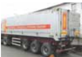
RENDERS SKM 34-36 , sklápěcí návěs NS1, r.v. 1999, cen. kategorie od 500 000; 41m 3 , AL korba, zvedací náprava, nápravy BPW, otevírací vrata (okénko), celk. hmot. 34 000 kg, užit. hmot. 26 600 kg, pohot. hmot. 7 400 kg, lož. výška 1800 mm, dl. 9250 mm, šířka 2450 mm
