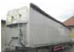
REISCH-WALKING FLOOR , spec. návěs - pohyblivá podlaha, r.v.1998, cen. kategorie od 750.000,- 85 m 3 , hliníkové boky, boční dveře po celé délce, zad. vrata, vrchní plachta, ABS, měchy, zved. náprava, nápravy BPW, otevírací vrata (okénko), celk. hmot. 34 000 kg, užit. hmot. 26 600 kg, pohot. hmot. 7 400 kg, lož. výška 1800 mm, dl. 9250 mm, šířka 2450 mm
