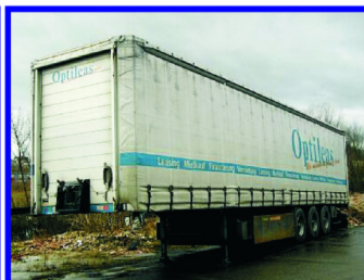
SCHWARMÜLLER, r.v.1998 valníkovaný návěs, třístranná shrnovací plachta, koš na palety, nové pneu, vyrovnání k rampě, zadní vrata, ABS, lož.výška 2.68m
