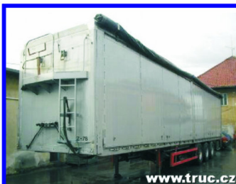
REISCH - WALKING FLOOR, r.v. 1998 pohybl.podlaha, 85m3, hliníkové boky, boční dveře po celé délce, zad.vrata, vrchní plachta, ABS, měchy, zved.náprava.
