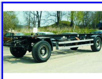
KRONE AZW 18, r.v. 1999 2osý kontejnerový přívěs BDF, ABS, pneu 385/64-22,5, užit.hm.15.140 kg (možnost skříňové nebo valníkované nástavby)
