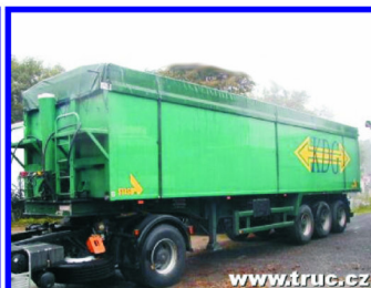
STAS 0-38/3 FAK NS1, r.v.1998 50m3, celohliníkový, nápravy ROR, plachta, AL disky, lož.délka 10.650mm, šířka 2.440mm, pohot.hmot.6.760kg, užit.hm.31.240kg, celk.hm.38.000kg
