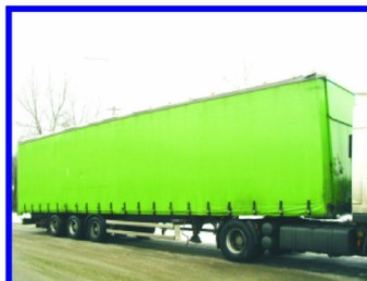
ASCA, val. návěs LOWDECK, r.v.1999 3osý, 13.6m, třístranná shrn.plachta (zelená), hydraulicky zvedací střecha, kurták, celková hmotnost 34.000kg, užit.hm.26.570kg, lož.výška 2.98m, lož.šířka 2.48m.
