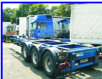
KORTEN NTC HIGH CUBE, r.v.1999 3osý, roztahovací nosič kontejnerů 20-30-40-45 stop, zvedací náprava 5ks
