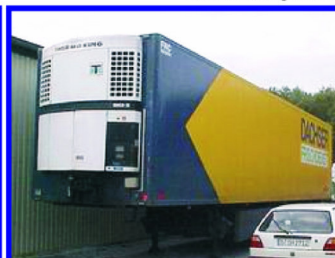
KIESLING, r.v.1998 mrazicí návěs,zvedací náprava, agregát Thermo-King, vložené patro, dělicí stěna, 33 nebo 66 palet, vnitřní výška 2.60 m
