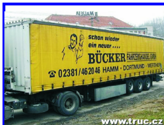
KRONE, r.v. 1999 3osý valníkovaný návěs, třístr.shrnovací plachta, kurták, lož.výška 2.73m, nápravy BPW, zvedací náprava, měchy, ABS, celk.hm.36.000kg, užit.hm.29.040kg, pohot.hm.6.960kg
