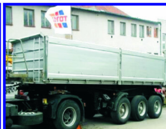
KÖGEL SK 24 NS3, r.v.1998 24m3, třístranný, AL korba, ocelové dno, zved.náprava, celk.hm.35.000kg, užit.hm. 28.250kg, pohot.hm. 6.750kg.
