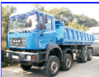
MAN 35,414 VFAK (8x8), r.v. 1999 třístranný sklápěč, 118,000 km, centr.mazání, klima, tempomat, celková hm, 32,000 km, užit.hm, 16,300 kg
