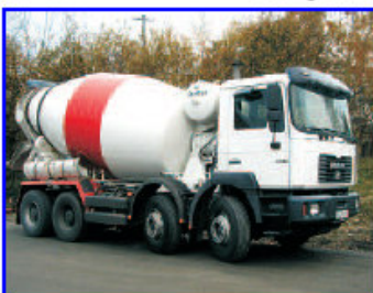
MAN 32,364 MIX, r.v. 2000 autodomčhávač, 360HP, nástavba Stetter, 9m3, pneu 80%
