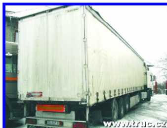
FRÜHAUF, r.v.1999 3osý valníkovaný návěs, 13.6m, třístranná shrnovací plachta, kurták, zad.vrata, zvedací náprava, celk.hm. 35.000kg, užit.hm. 28.100kg, pohot.hm. 6.900kg, lož.výš. 2.70m.
