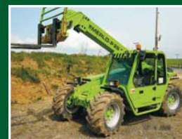
MERLO P26.6LP a LPT r.v. 2001 - 2004 z=6m./2.600kg, klima, hydr.vývody+závěs, 40km/h, dle kusu
