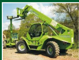
MERLO P30.13EVS; P32.12EVS P35.12K; P40.16 a P40.17K P101.10HM a ROTO 30.16 r.v. 1997 až 2007 nosnost až 10t, zdvih 7 až 17m 40KM/h, svahovka+boční výkyv ramene aut. adaptéry, ..od 500.000,- Kč
