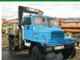
PRAGA V 3S M6 hákový nosič kontejnerů + HR 3001, motor Avia Turbo, servo, přestavba v r.1996
