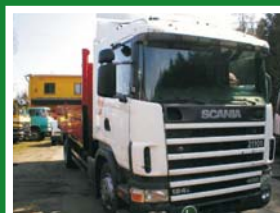
SCANIA 124/400 valník + HR r.v. 1998 valník 6,20m hydr. ruka HIAB 090, 7m/1200kg
