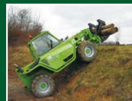
MERLO P27.9EVX a 30.9EVX r.v. 2000 3.000kg/9m, svahovka+boční výkyv ramene,
