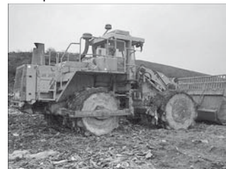
motor Cummins 6V - 216 kW, hydropřevod. ZF 3 WG 250, dobrý startér, turbo, kardan, kladka a vrtule větráku / jde jen 1. převod, nejde vzduch + brzdy, trny kola jen 10 cm, škrabáky bez nožů, r.v. 2000, stav v provozu, okr. TP tel.: 608244776, 608244780
